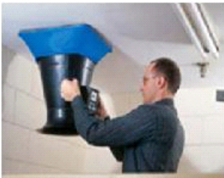
Figura # 9. Equipo para medir la cantidad de aire extraída por una rejilla
