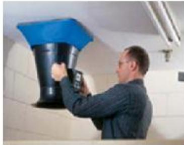
**Figura # 18. Equipo para medir la cantidad de aire extraída por una rejilla**
