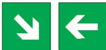
Figura # 34. Señalización de dirección tramos de recorrido de evacuación que conducen a salidas. Pictograma 24 (P-24).
