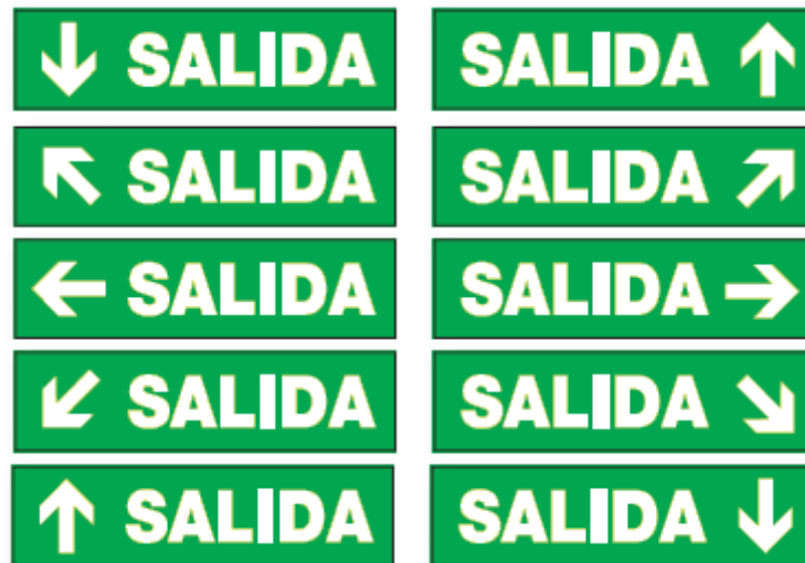
Figura # 31. Señalización de tramos de recorrido de evacuación que conducen a salidas habituales.
