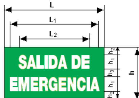
Figura # 29. Señalización de salidas de emergencia Señal literal (S.L. - 2).
