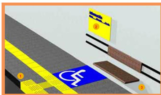
Figura 1. Configuración básica de parada de autobús.
